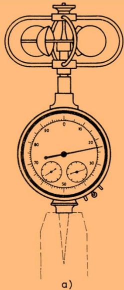
Ručni anemometar: a – s mehaničkim i b – s električnim prijenosom
